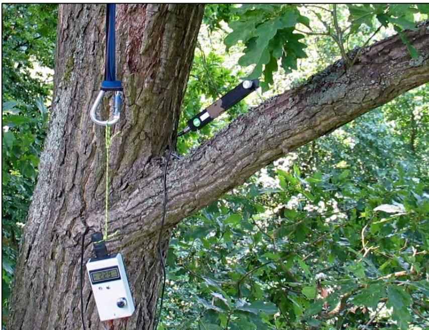
einem Zugversuch die Dehnung zwischen den Nadeln erfasst werden (WESSOLLY & ERB 1998). In unserem Falle wurde die Verkürzung der repräsentativen Randfaser und damit die Stauchung gemessen. Beim Einbau wurde darauf geachtet, das Gerät auf einem geraden Astabschnitt zu installieren, um Fehlmessungen durch schon vorhandene
